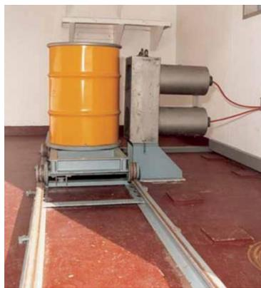
Figure 36 : Photo de la mesure d'un fût de 100L [14].
